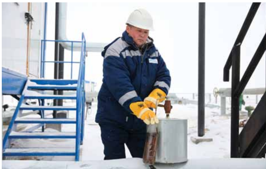
Мұнайды сұрыптауға алу үдерісі / Процесс отбора на пробу нефти / Oil intake for testing
